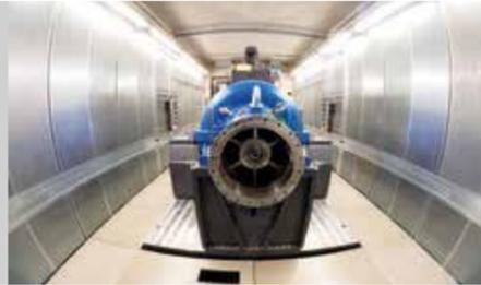
El sistema experimental de suministro de aire fabricado por AERZEN permite controlar los bancos de ensayo (en este caso turbina de aire) de forma dinámica con rampas de carga seleccionables casi con total libertad.
