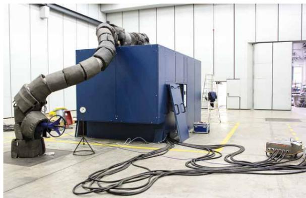
Das Delta Screw Aggregat VML 250 beim Funktionstest in der AERZEN Akustikhalle
