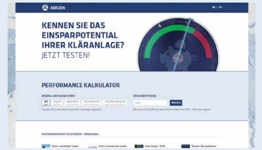
Auf Basis von Maschinenanzahl, Volumenstrom und Druckdifferenz errechnet der Kalkulator ein erstes Einsparpotenzial.
