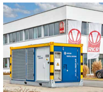
Die Verdichtereinheiten von Aerzen Rental – hier vor dem Gebäude der RKR Gebläse und Verdichter GmbH – lassen sich im Container schnell und sicher transportieren.
