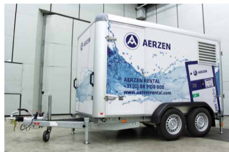
Der mobile Aerzen Turbo AT50-Anhänger kann von einem Pkw gezogen werden.
