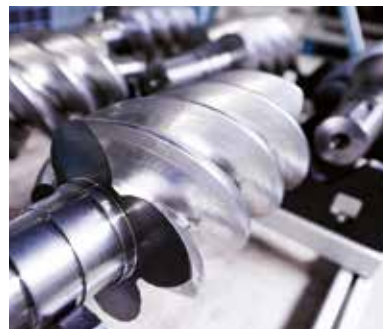
Bei höheren Drücken überlegen: Rotorprofile von Schraubenverdichtern
